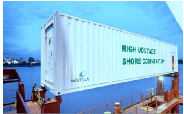
Wärtsilä's SAMCon shore-connection container (Photo courtesy Wärtsilä)
